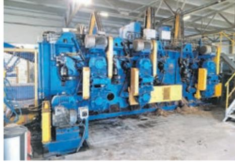
работы производственных линий. В августе по чертежам работников лесопильного цеха в УМЗ были изготовлены усиленные валы для окорочного станка. Они заменили импортные детали, которые использовались в работе ранее. По итогам двухнедельных испытаний оборудование с новыми запчастями полностью справилось с нагрузкой.
