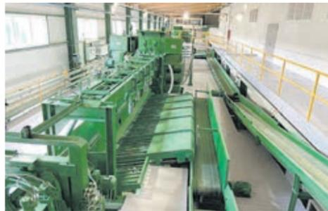
Вельский лесопромышленный комплекс внедряет в производство новые узлы и агрегаты собственного изготовления. Специалисты предприятия самостоятельно разработали чертежи внутренних прижимных роликов пильной линии и совместно с инженерами УМЗ смогли их изготовить. Сейчас новые детали уже заменили устаревшие импортные узлы и проходят тестовые испытания в реальных условиях. По словам специалистов, их разработка показывает себя эффективно, они отвечают всем требованиям качества и надежности.
